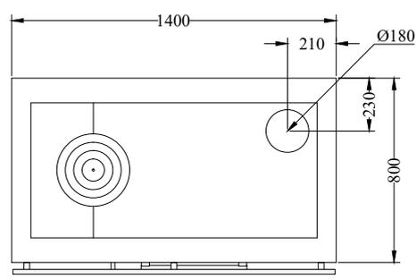
Versione con uscita fumi a destra. La versione con uscita fumi a sinistra è simmetrica.
